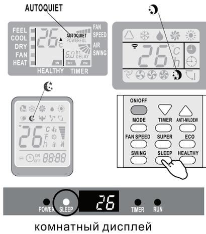
В режиме обогрева температура постепенно снижается на 2°C в течение первых 2 часов работы.
