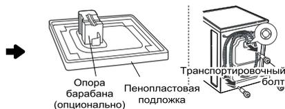
Снимите транспортировочные болты и опоры.
