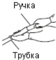
3. По мере необходимости вы можете использовать одну или две секции удлинительной трубки, соединив их между собой.
