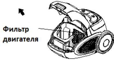
Промойте фильтр прохладной водой под краном. Запрещается мыть фильтр горячей водой или использовать для его мытья моющие средства.
