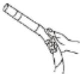
Вы можете также изменять мощность всасывания, открывая или закрывая воздушную заслонку на ручке.
