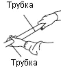
4. Установите на трубку подходящую насадку.
