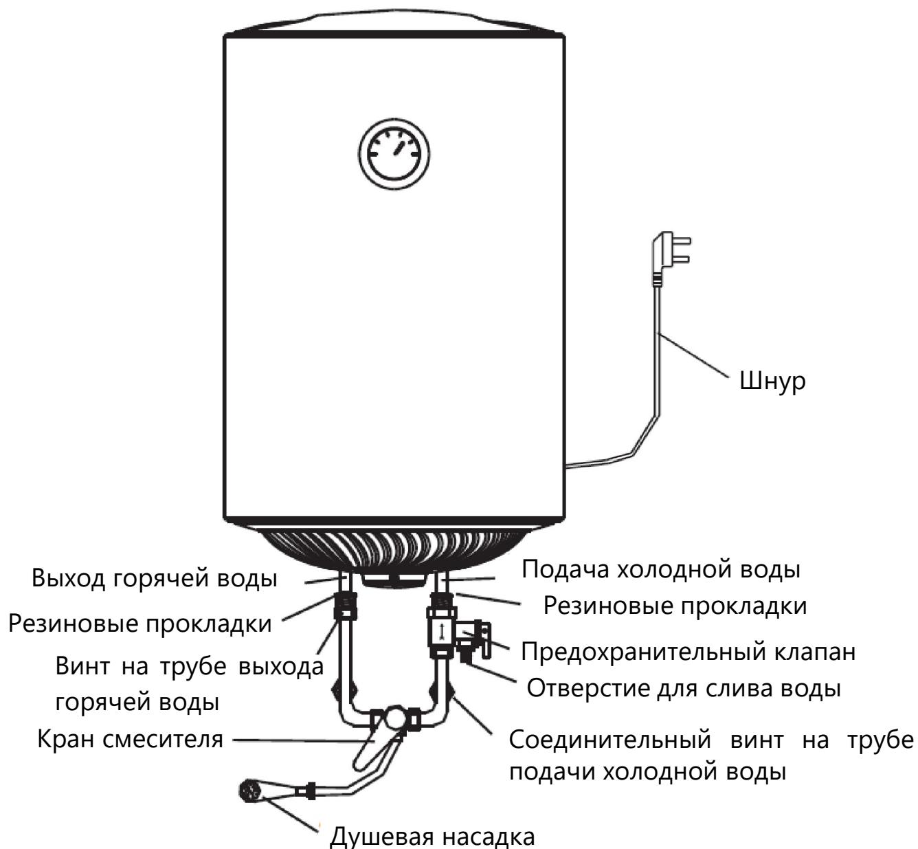
Для подключения водонагревателя к системе водоснабжения с различными выходами, руководствуйтесь приведенными схемами.
