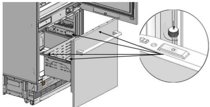
Снимите дверцу морозильного отделения отвинтив два шурупа в передней части направляющих.
