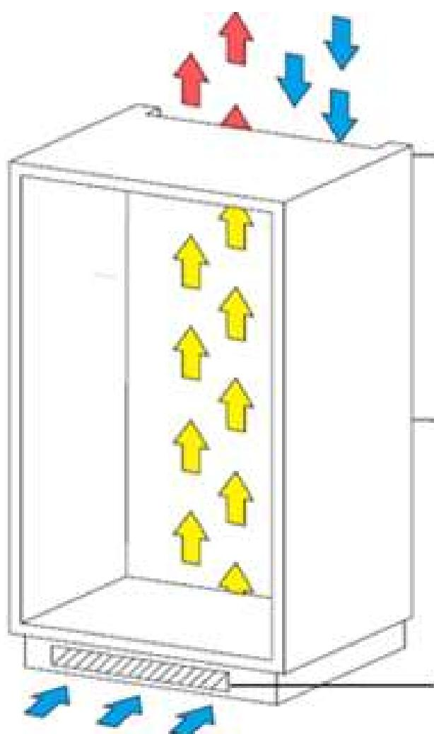
Сделайте зазор для вентиляции в верхней части шкафа. Воздушному потоку ничто не должно препятствовать.
