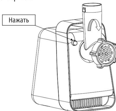
Чтобы снять камеру мясорубки, одной рукой нажмите на кнопку для установки и снятия камеры, а другой возьмитесь за камеру и поверните ее по часовой стрелке.
