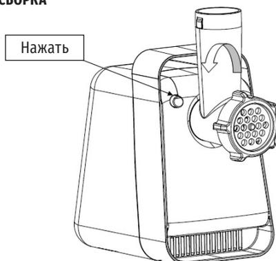
1. Одной рукой возьмитесь за корпус мясорубки и большим пальцем нажмите на кнопку для установки и снятия камеры мясорубки на корпусе,
