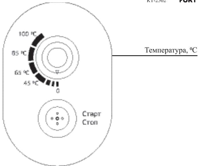
На контрольной панели термопота имеется 1 ручка управления и кнопка «Старт/Стоп». Кнопка подсвечивается круглым двухцветным индикатором.
