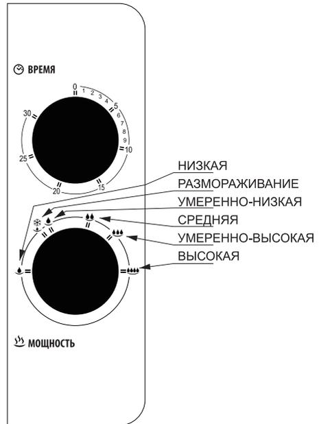
На панели управления расположены регулятор мощности работы микроволновой печи и регулятор времени приготовления/размораживания.
