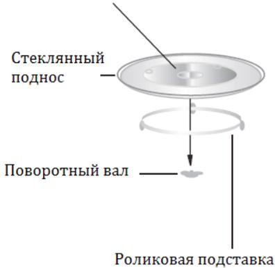
На поворотную ось устанавливается стеклоподнос. Под стеклоподнос устанавливается роликовая подставка, которая помогает подносу свободно вращаться. Вращение пищи во время работы печи способствует ее равномерному приготовлению.
