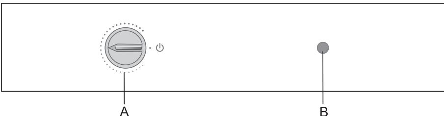
А Переключатель вкл./выкл. и установки температуры
