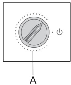
Если температура в помещении, где установлен прибор, ниже +16°C, рекомендуем установить переключатель в область, обозначенную толстой линией.
