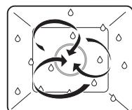
Воздух в камере нагревается нагревательным элементом, расположенным за задней стенкой камеры, и равномерно циркулирует. Из камеры выводится минимальное количество возникающего пара. Влажность продуктов сохраняется.
