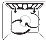
Нагрев осуществляется с помощью нагревательных элементов гриля. Воздух в камере прибора циркулирует равномерно за счет нагнетателя горячего воздуха.
