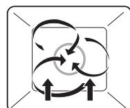
Нагрев осуществляется с помощью горячего воздуха и нижнего нагрева. Низ продукта пропекается более интенсивно.
