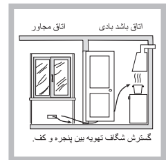
نمونه های متفاوت تهویه برای هوای کمک احتراق.
