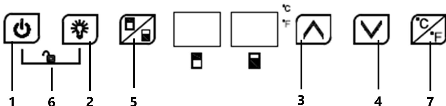
Обратите внимание, что при подключенном питании, панель управления прибора по умолчанию заблокирована. Для разблокировки нажмите одновременно на кнопки «Включение/Выключение» и «Подсветка» и удерживайте нажатыми в течение 3 секунд.
