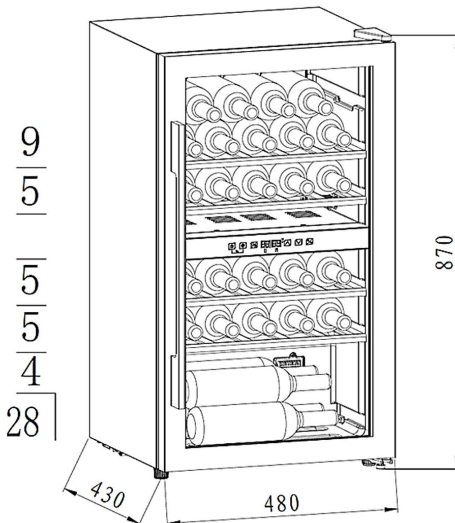
Винный шкаф снабжен съемными полками для удобного хранения вина. Вместимость данной модели винного шкафа составляет 28 бутылок (стандартные бутылки формы «Бордо», объем 750 мл).
