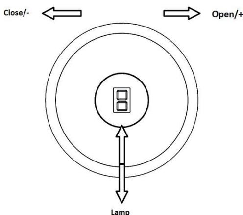
**Control Knob – Ручка управления:** Когда вы вращаете ручку по часовой стрелке; ваше устройство начинает работать, и если вы продолжите вращать, скорость работы увеличивается. Когда вы поворачиваете ручку против часовой стрелки, ваше устройство продолжает сокращать количество циклов и в конечном итоге отключается. Вы можете включить подсветку в зоне приготовления пищи, нажав ручку управления.
