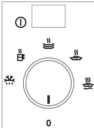
На панели управления расположены переключатель режимов и двухпозиционный выключатель Вкл/Выкл. Панель управления видна только в открытом положении выдвижного ящика.
