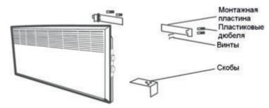
С помощью монтажного комплекта установите обогреватель на стене у пола. Расстояние от прибора до пола должно быть не менее 10 см.
