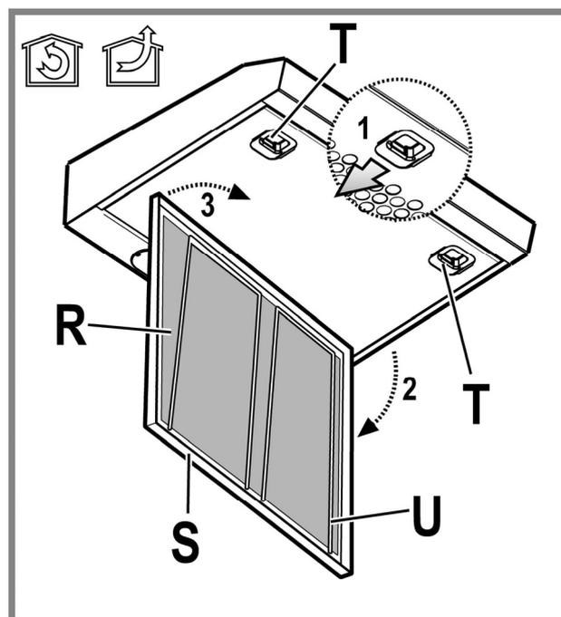
**Le filtre métallique autoportant** n'a pas de grille de support, pour l'enlever, tirer les ressorts de décrochage vers l'arrière et extraire le filtre vers le bas.
