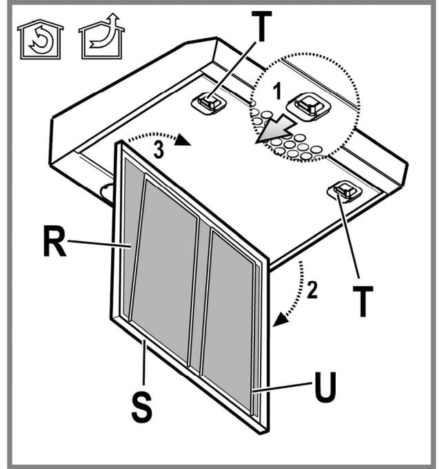
**Taşıyıcı metalik filtresinin** destek ızgarası yoktur, yerinden çıkartmak için kurtarma lastiklerini arkaya doğru çekiniz ve filtreyi aşağıya doğru çekerek çıkartınız.
