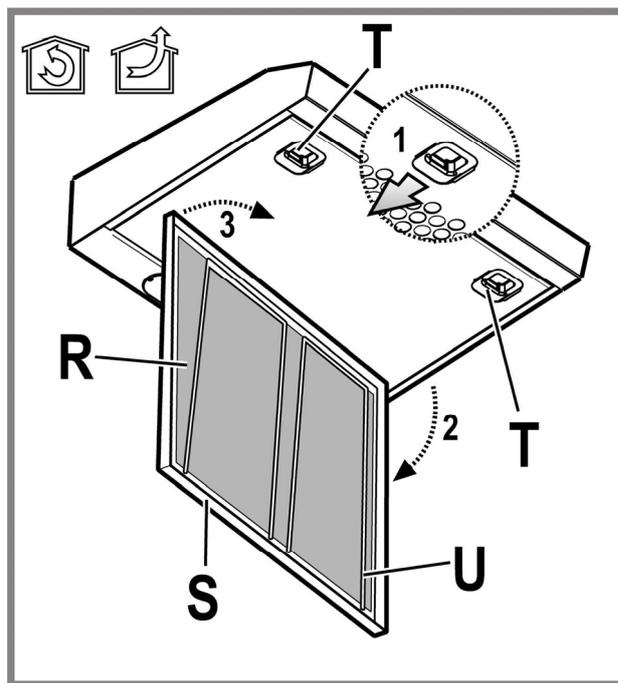
**Samonosný kovový filter** nemá podpornú mriežku, k jeho odstránení treba vyťiahnuť pružiny dozadu a vyjmite filter smerom dolu.
