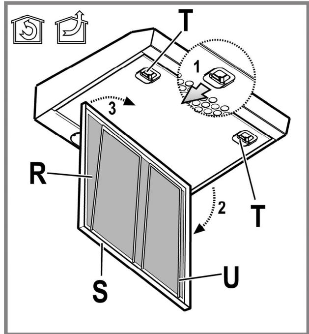
**Der selbsttragende Metallfilter** ist nicht mit einem Haltegitter versehen; um ihn herauszunehmen, die Öffnungshaken nach hinten ziehen und den Filter dann nach unten herausnehmen.
