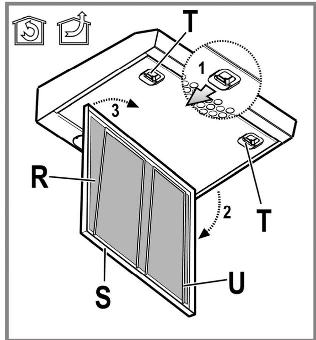
O **filtro metálico autoportante** não tem grelha de suporte; para removê-lo, puxar as molas de desengate para trás e extrair o filtro por baixo.
