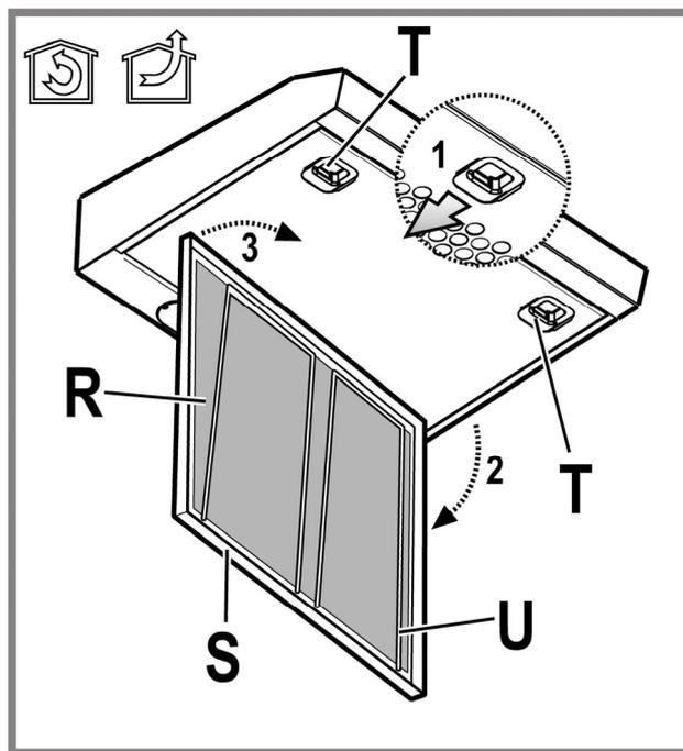
**Το αυτόματο μεταλλικό φίλτρο** δεν έχει σχάρα υποστήριξης. Για να το απελευθερώσετε τραβήξτε το έλασμα απελευθέρωσης προς τα πίσω και αφαιρέστε το φίλτρο προς τα κάτω.
