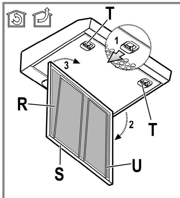
**Самонесущий металлический фильтр** не снабжен несущей решеткой; для снятия его, тяните фиксаторы назад и выньте фильтр книзу.
