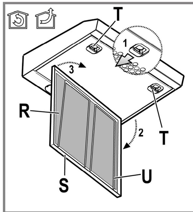
**Металевий само несучий фільтр** немає опорної решітки, для його зняття потягнути за розчіпні пружини назад та витягнути фільтр вниз.
