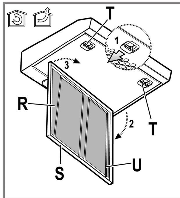
**Het zelfdragende metalen vetfilter** heeft geen steunrooster, om het filter te verwijderen de sluitingsveren naar achteren trekken en het filter naar beneden toe verwijderen.
