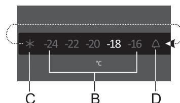
Цифры  $-24$ ,  $-22$ ,  $-20$ ,  $-18$  и  $-16$  обозначают температуру в приборе в градусах Цельсия ( $^{\circ}\text{C}$ ).
