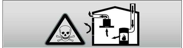
Источники пламени с подводом воздуха из помещения (например, работающие на газе, жидком топливе, дровах или угле нагреватели, проточные водонагреватели, бойлеры) получают воздух для сжигания топлива из помещения, где они установлены, а отработавшие газы отходят через вытяжную систему (например, вытяжную трубу) из помещения на улицу.
