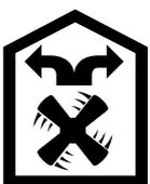
Вытяжка всасывает воздух, который очищается, проходя через жирулавливающие и угольный фильтры, а затем возвращается обратно в кухню.
