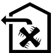
Вытяжка всасывает воздух, который очищается, проходя через жирулавливающие фильтры, а затем выводится по системе труб наружу из здания.
