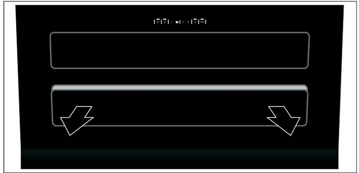
3. Сдвиньте вентиляционную заслонку в креплении вправо и снимите её.
