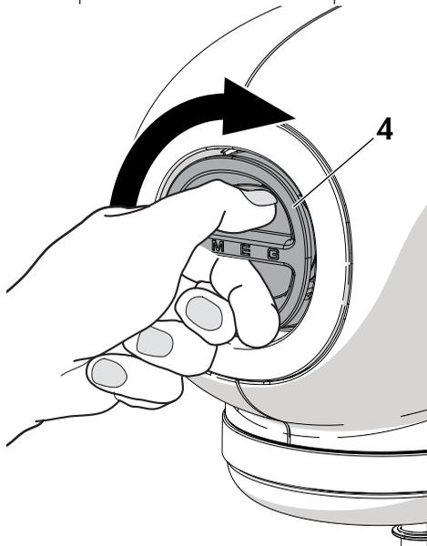
7. Потяните наружу, чтобы снять защитное приспособление (4).
